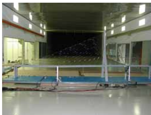
照片 9 橋梁風洞實驗
