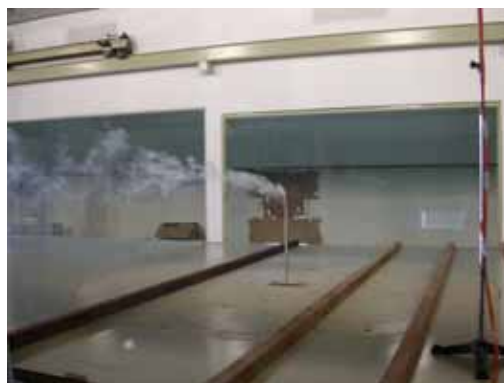
照片 11 煙流擴散實驗
