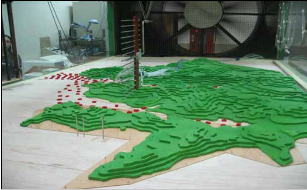
圖 3-4 協和火力電廠四周地形風洞模型及採樣系統實驗照片
