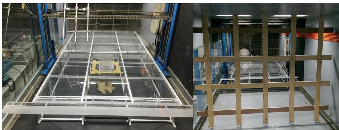
圖 3：風洞內端版架設與柵板設置
