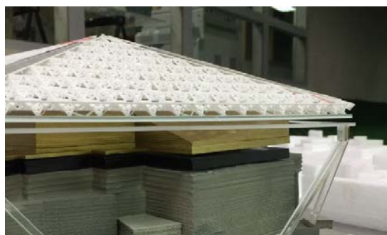
圖 7 整體屋頂高頻力平衡儀(HFFB)風洞試驗
