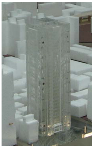
圖 19 百世大樓風壓試驗模型
