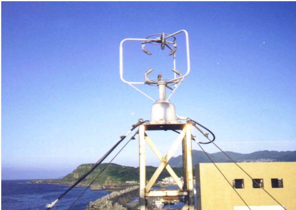
圖 3 基隆海岸測站日本 KAIJO 三向(軸向、橫向、與垂直向三分量)超音波風速計(Model FA-600BT) (Shiau, 2000)
