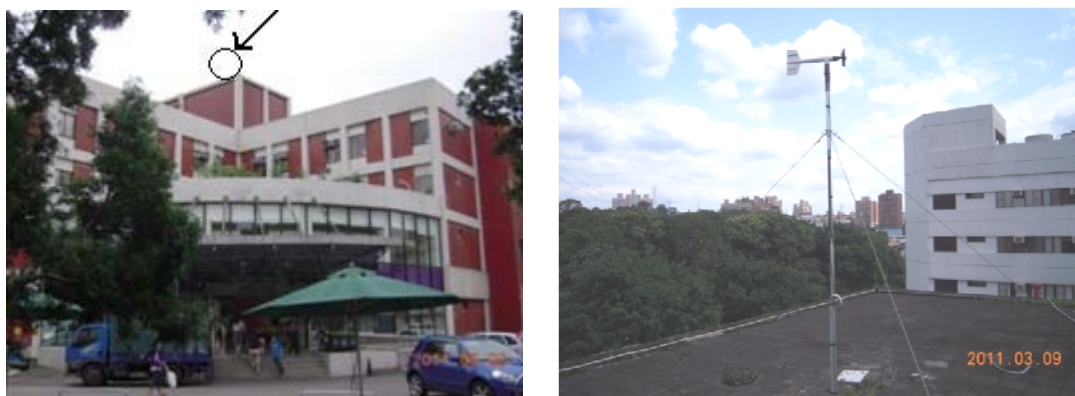
圖 4 台北南港測站及風速計 Young 05106 設置照片 (Shiau, Chen, Wang, & To, 2012)
