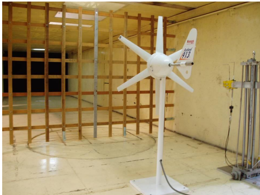
圖 9. 柵網紊流對水平軸式風機影響之風洞實驗
