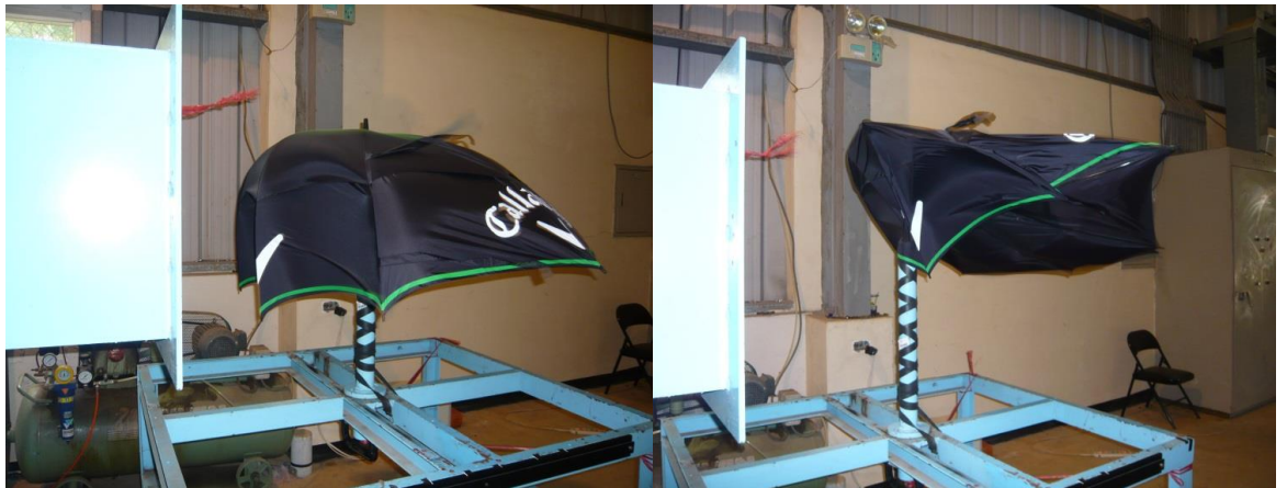
圖 7. 中型風洞測試雨傘耐風強度之照片
