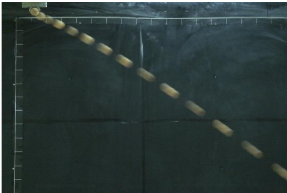
圖 17. 風吹落物落下軌跡之照片
