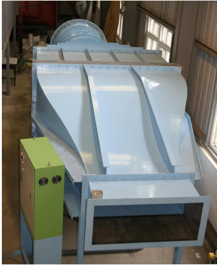
圖 6. 中央大學中型風洞的照片
