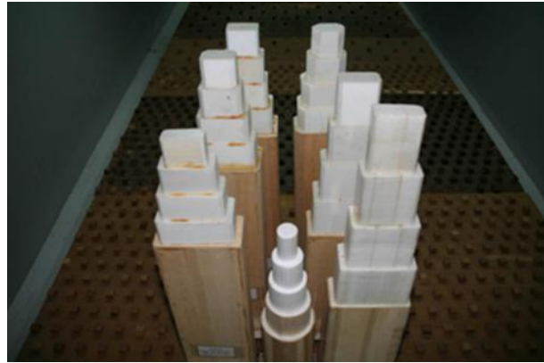
圖 3. 風力實驗專用巴沙木高層建築模型
