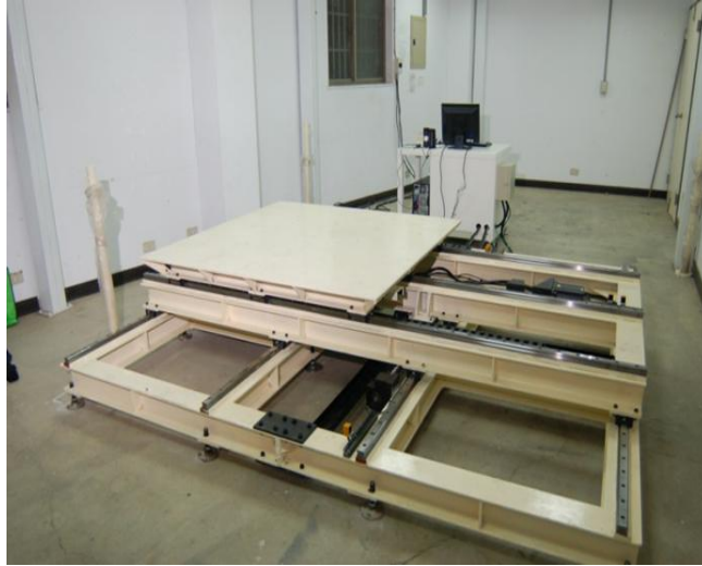
圖 13. 舒適度實驗-水平兩軸向振動台
